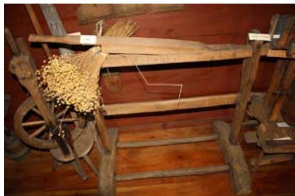
Cierlica służąca do ocierania włókien lnu i konopi z paździerzy
